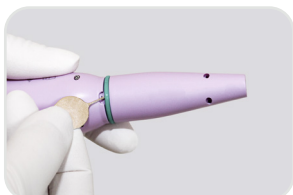
Remplacement du joint torique sur le boîtier du moteur
